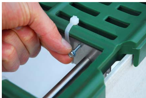
10. Schraube unmittelbar im Anschluss in den noch weichen Kunststoff eindrehen.
