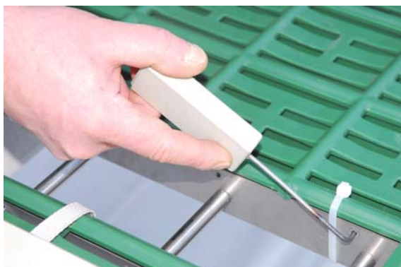
9. Werkzeug mit Flamme erhitzen & Löcher schmelzen. Spitze komplett durchdrücken.
