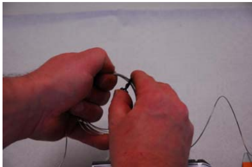
Schritt 12: Fühlerröhrchen vorsichtig zusammennehmen und mit Kunststoffklemme einbinden...
