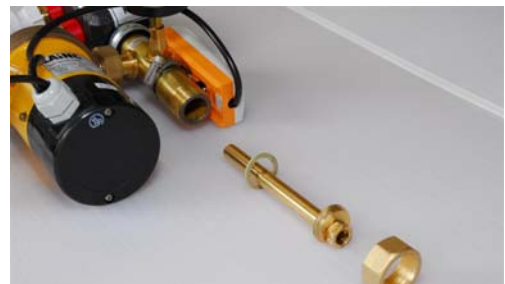
Schritt 5: Einbaureihenfolge der Neuteile
